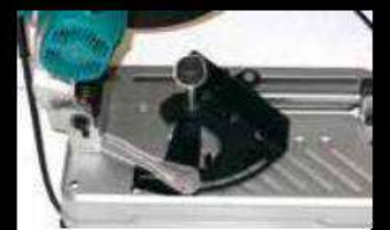
Ajuste rápido para una fijación de la pieza de trabajo.
