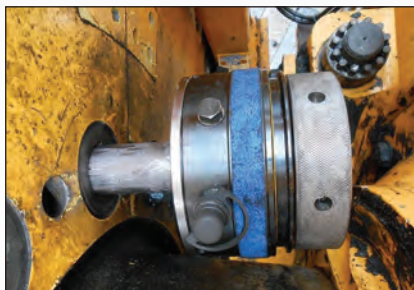
◀ Tensionador personalizado para remover parafusos em uma retomadora.
