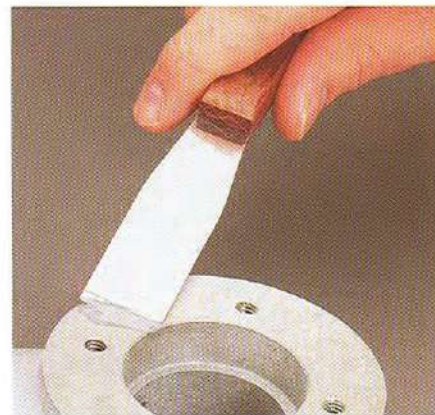
La masilla de aluminio Aluminum Putty puede utilizarse para reparar o reconstruir piezas fundidas de aluminio.
