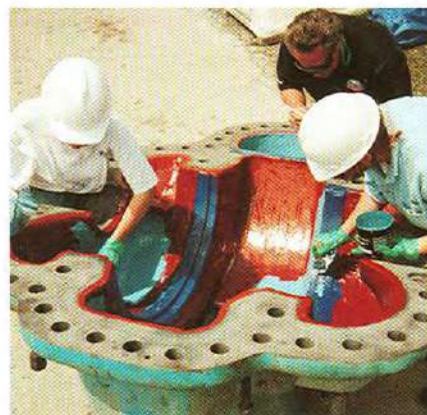
Brushable Ceramic llena orificios y cavidades en piezas fundidas, eliminando vacíos donde la suciedad puede depositarse, proporcionando una superficie lisa que asegura el flujo uniforme de materiales.
