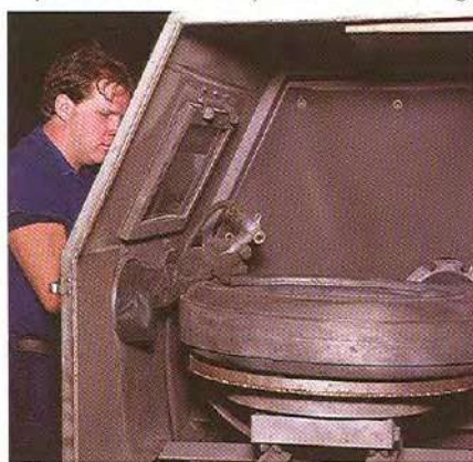
Eliminar toda la contaminación de las superficies metálicas mediante chorro abrasivo, arenado u otro medio mecánico.
