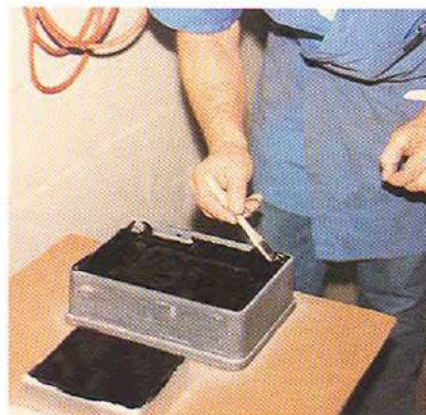
Flexane® 80 Liquid se utiliza para hacer patrones de moldes, reproduciendo fielmente detalles intrincados.
