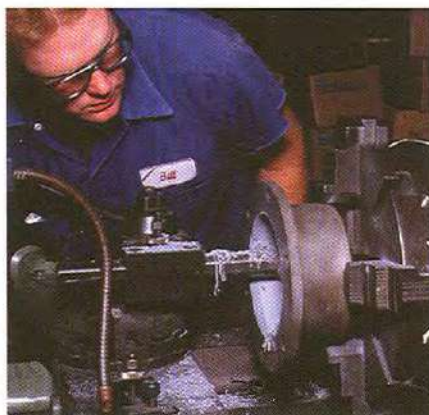
Un epoxi maquinable de alto rendimiento, FasMetal se puede aplicar en temperaturas tan bajas como 5° C. Endurece en una hora, lo cual lo hace ideal para reparaciones de emergencia.
