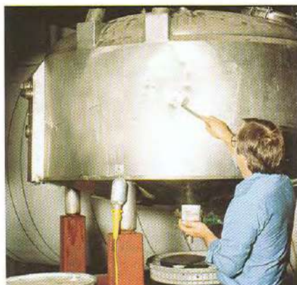
Stainless Steel Putty es ideal para reparaciones que no se oxidan de equipos de procesamiento de alimentos de acero inoxidable.
