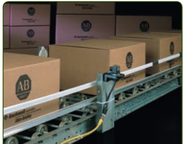
Aplicación de manejo de materiales – Un RightSight retrorreflexivo detectando paquetes en una línea de transportador.
