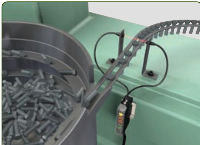
Detección de piezas pequeñas – La fibra óptica 45FPL asegura el flujo continuo de piezas pequeñas que salen del alimentador.
