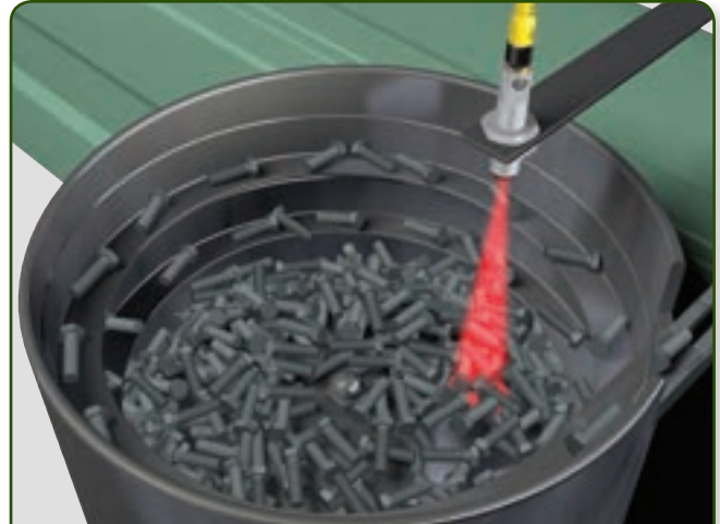
Aplicación en recipiente alimentador – Un 42CM monitorea el nivel del recipiente para evitar el desbordamiento de componentes. Este modelo cuenta con supresión del plano de fondo, por lo que ignora las reflexiones que provoca el recipiente y detecta de manera precisa solo los componentes.
