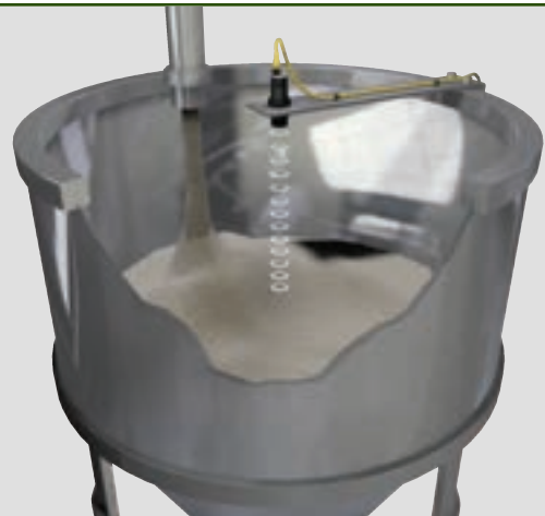
Diámetro de rollo y nivel de tanque – Un 873P analógico ultrasónico mide continuamente el diámetro del rollo o el nivel del tanque, y entrega una salida proporcional entre 4...20 mA o 0...10 VCC. Si se utilizan dos sensores de salida discreta, se puede establecer un punto de conmutación para indicar nivel bajo y otro para indicar nivel completo.
