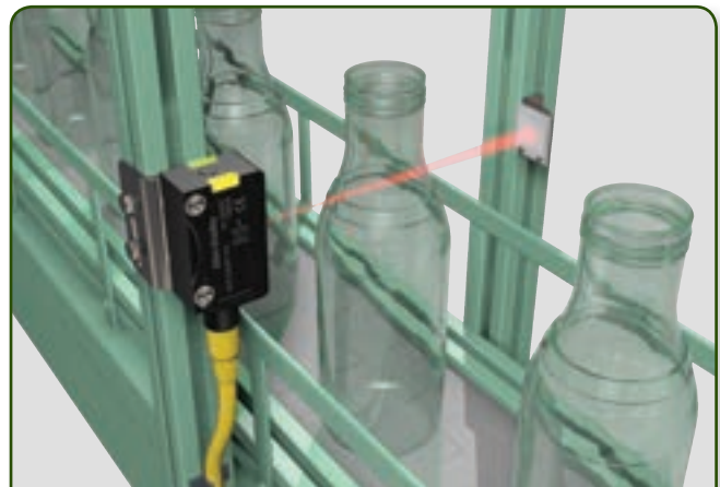
Detección de objetos transparentes – los objetos transparentes, tales como botellas, son difíciles de detectar para los sensores estándar porque el láser pasa a través del objetivo. Sin embargo, gracias a su óptica especial, el sensor de objetos transparentes 42JT detecta de manera confiable estos objetos.
