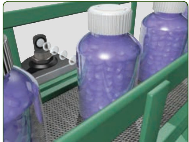
Recuento de piezas – Un 873M en ángulo recto cuenta botellas que debido a su color, brillo y claridad pueden ser difíciles de detectar para los sensores fotoeléctricos.
