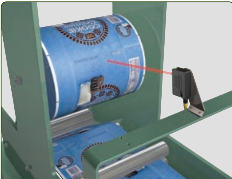
Diámetro de rollo – Un sensor 45LMS mide el diámetro de un rollo para controlar su velocidad y prevenir su desvío.
