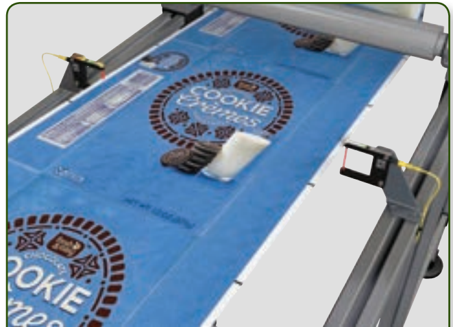
Aplicación de alineamiento de bobina – Dos sensores de horquilla 45LSP monitorean la posición de la cinta a ambos lados del rodillo. Si la cinta se desvía en cualquier dirección, el haz de luz del sensor se interrumpirá, lo que hará que el brazo compensador de la máquina corrija su posición.
